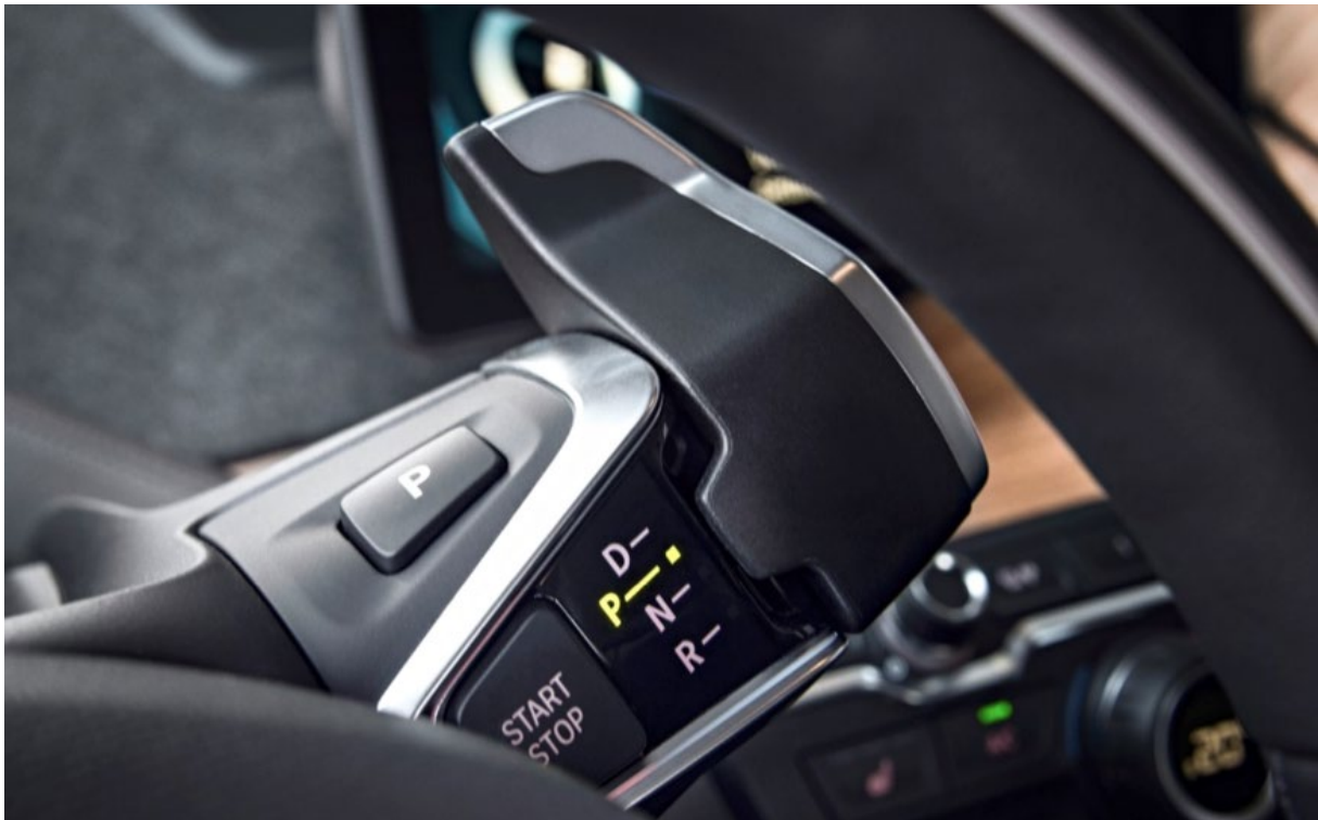
Figure 1: de 'drive selector' hendel achter het stuurwiel van de BMW i3.
